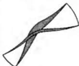
der Vorder- wie auch an der Rückseite in jeglichen Entfernungen von der Mittelachse eine trochoidale oder eine ähnliche Wellenform haben, deren Scheitel in Bezug auf die Bewegungsrichtung des Schiffes nach vorn gerichtet ist. — Der Erfinder glaubt durch diese Form einen besseren Nutzeffekt erzielen zu können.
